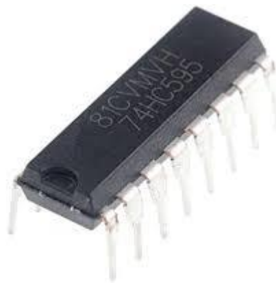
Figur 10: 4-bitars skiftregister bild 3 (DroneBot Workshop, 2023)
