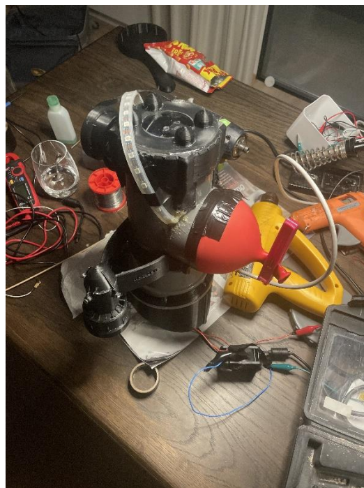
Figur 52: Ballongtest för vattentätthet
